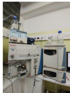
Chromatograf ciekłowy sprzężony z tandemowym spektrometrem mas (LC-MS/MS) firmy Thermo TSQ Vantage z automatycznym podajnikiem próbek Thermo Finnigan Surveyor Autosampler.
